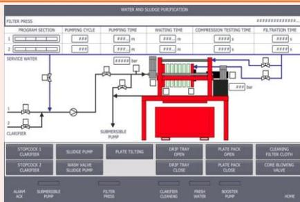
・運転制御はセンサーによって自動的に制御され、汚泥の搬入・脱水ケーキの排出・脱離液の排出・洗浄作業までを全て自動で行います。
