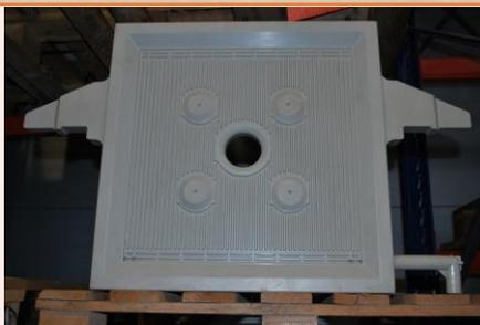
・特殊なフィルター（ドイツ製）を使用することで、通気性、透水性、耐久性に優れ、従来機より、短時間での脱水処理が可能となります。
